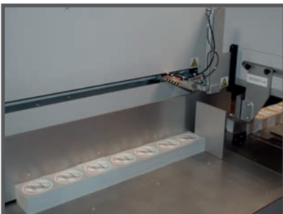
1. Manuelles Einlegen und Ausrichten der Produktstapel
