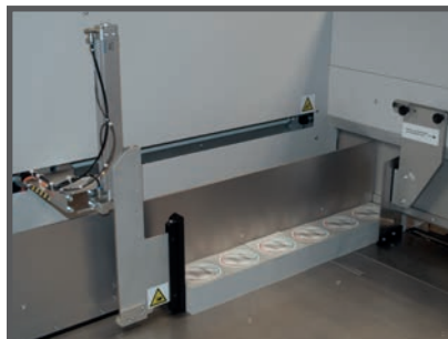
2. Automatisches Zuführen und Pressen der Produktstapel
